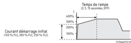
Généralement, le mode démarrage par rampe de courant s'utilise dans deux situations.
