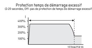
Cela permet d'avoir une indication précoce du changement des conditions de l'application ou de savoir que le moteur a calé. Ce paramètre peut également protéger le démarreur contre le fonctionnement en dehors de sa capacité nominale de démarrage.
