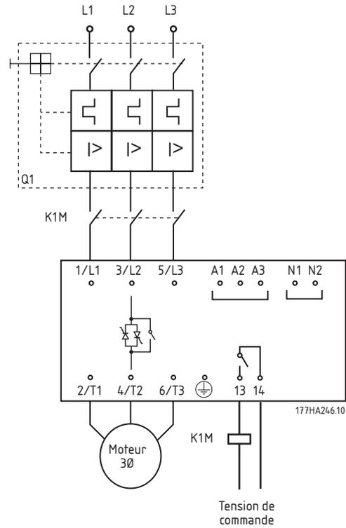
Exemple 3 - MCD 201 installé avec disjoncteur, surcharge et contacteur de ligne.
