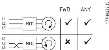
Le MCD 202 proprement dit est insensible à la rotation de phase. Cette fonction permet de limiter la rotation du moteur à un seul sens. Régler la protection selon les besoins de l'application.
